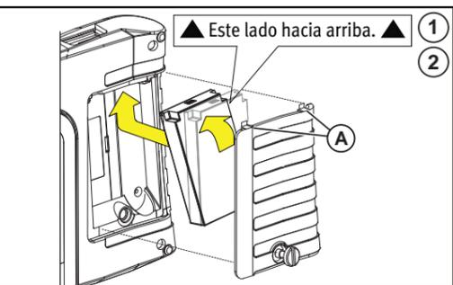
1. Retire la cubierta del paquete de baterías y coloque el paquete de baterías (como se muestra) con las flechas hacia arriba. Incline la parte superior de la batería hacia adentro para alinear las lengüetas y, a continuación, hacia abajo para colocarla.
